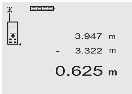
個々の距離は容易に減算することができます。例えばパイプの下端から天井までの距離を測定する場合などです。床から天井までの距離から、床からパイプ下端までの距離を引くことによりさがり距離が求められます。さらにパイプ直径を差し引くと、パイプ上端から天井までの距離が求められます。
