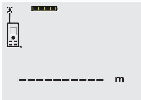
対象面に照準を定めます。測定ボタンをもう 1 回押して、距離を測定します。測定結果は通常 1 秒以内に測定値ラインに表示され、レーザー光線はオフになります。
