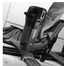
Крепление гофры / трубок металлической или текстильной лентой
